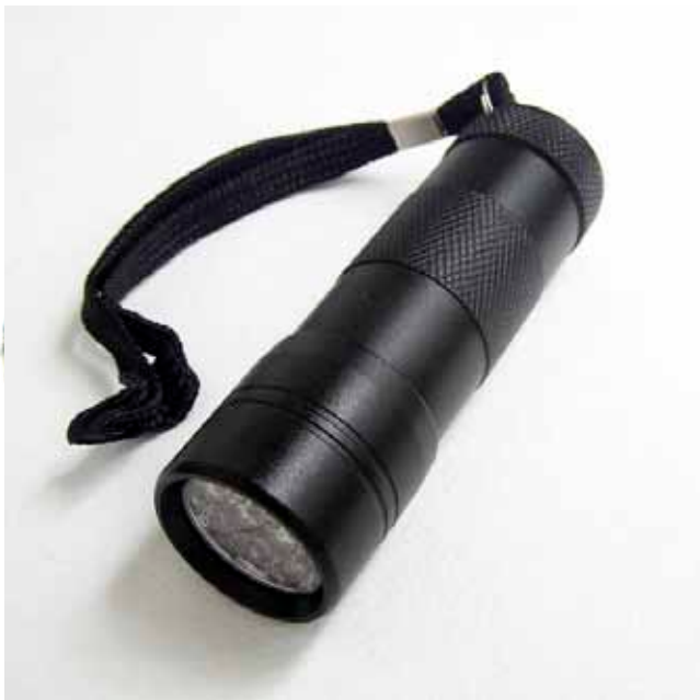
Рисунок 2. Внешний вид ультрафиолетового фонаря, применяемого для изучения светящихся минералов.
